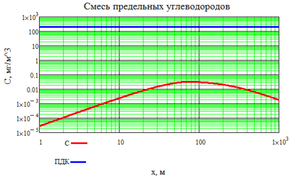
Рисунок 10 - Зависимость концентрации смеси предельных углеводородов от расстояния от агрегата нейтрализации паров и промстоков
